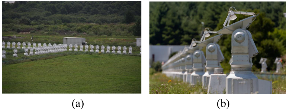
図 6.8 野辺山宇宙電波観測所の太陽電波干渉計。口径 80 センチメートルのパラボラアンテナ 84 基で構成されている (Wikipedia より)
