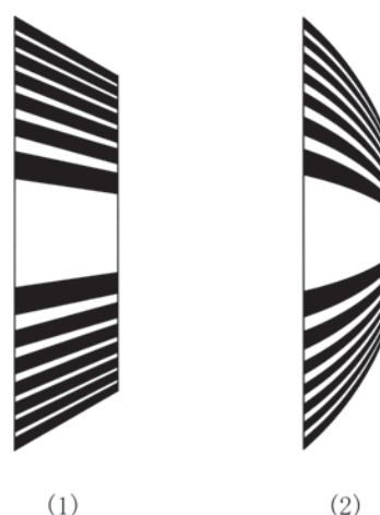
図 10.25 多層膜ラウエレンズの高分解能化 37) (1) 楔型 (wedged) (2) 曲線型 (curved)
