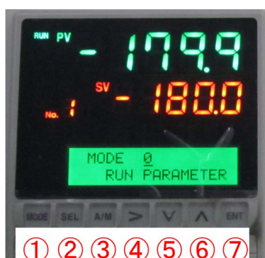
図 A.2 図 A.1 で「① [MODE] ボタン」を 1 回押したところ
