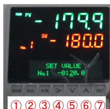
図 A.3 図 A.2 で「② [SEL] ボタン」を 1 回押して設定温度を -120^{\circ}\text{C} に変更したところ
