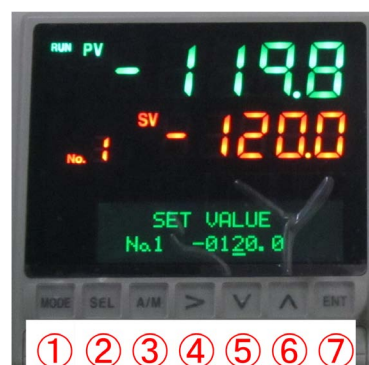
図 A.4 図 A.3 で「⑦ [ENT] ボタン」を押すとオレンジおよび水色で表示された温度が、 -120^{\circ}\text{C} に向けて上昇してゆきます
