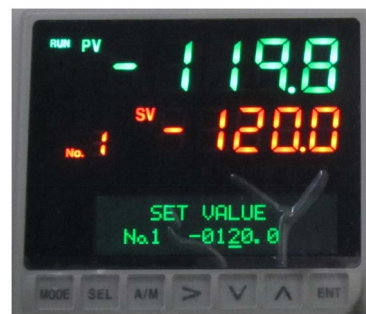
図 A.4 図 A.3 で「[7] [ENT] ボタン」を押すとオレンジおよび水色で表示された温度が、 -120^{\circ}\text{C} に向けて上昇してゆく
