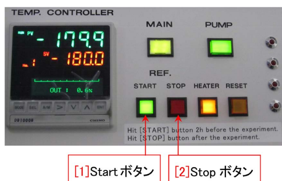
図 1.1 冷チッ素発生装置操作パネル
