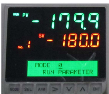
図 A.2 図 A.1 で「[1] [MODE] ボタン」を 1 回押したところ
