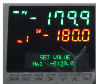
図 A.3 図 A.2 で「[2] [SEL] ボタン」を 1 回押して設定温度を -120^{\circ}\text{C} に変更したところ
