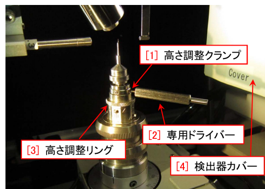
図 3.6 ゴニオメーターヘッド付近
